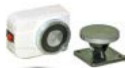
**ELETTROMAGNETE PER PORTE TAGLIAFUOCO** - Fermo elettromagnetico per tenuta porte R.E.I. con forza di tenuta 100 kg. Contenitore termo-plastico in ABS bianco, nucleo in acciaio completo di contro-placca snodata e ammortizzata con piattello in acciaio. Funzionamento a rilascio porta in mancanza di alimentazione o tramite pulsante di sblocco manuale di colore rosso (compreso). Circuito di protezione contro sovratensioni, montaggio a parete e a pavimento. Dimensioni: 72 x 105 x 52 mm..
