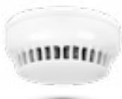
**RILEVATORE WIRELESS MULTICRITERIO** - Rivelatore fumo-temperatura via radio multicriterio (Fumo - Fumo e soglia fissa temperatura - Soglia fissa temperatura - Fumo o soglia fissa temperatura - Rilevazione termovelocimetrica - Fumo e rilevazione termovelocimetrica - Fumo o rilevazione termovelocimetrica). Portata via radio fino a 500 m in aria libera. Alimentazione tramite batterie 2 X R123A (non incluse). Certificato EN 54-5, EN 54-7 e EN 54-25.
