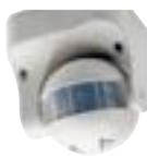
Rilevatore di presenza ad infrarossi da esterno per utilizzo di accensione luci e lampioni, non utilizzabile per allarme. Area di rilevazione 12 m per 90° di apertura. Alimentazione 230 Vca. Portata del relè 1.100 W con lampade ad incandescenza e 500 W con lampade fluorescenti. Tempo di accensione regolabile da 5 s a 10 min. Provvisto di cellula crepuscolare. Dimensioni: 134 x 86 x 96 mm.
