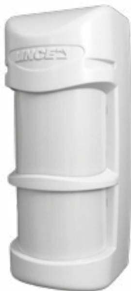
Rilevatore via radio tripla tecnologia da esterno Serie GOLD 869 con portata fino a 1,5 km in aria libera. Rilevazione tramite 2 PIR ed una microonda a 24 GHz, altezza di installazione 1-1,2 m con area di copertura di 12 m ed apertura di 85°. Impostazioni eseguibili direttamente dalla centrale quali settaggi AND/OR (triplo AND, doppio OR, l'esclusione della microonda ecc.), sensibilità dei PIR, portata della microonda e della rilevazione al mascheramento.
