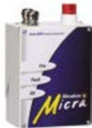
RIVELATORE AD ASPIRAZIONE CON CAMPIONAMENTO LASER MICRA 25 - Range di funzionamento da alta a bassa sensibilità (0,002÷25% obs/m). Un (1) ingresso per tubazione 3/4". Lunghezza massima tubazione 50 m (25m in modalità "alta sensibilità"). Completo di staffa per fissaggio a muro. IP50. Necessita di alimentazione esterna 24 Vcc.
