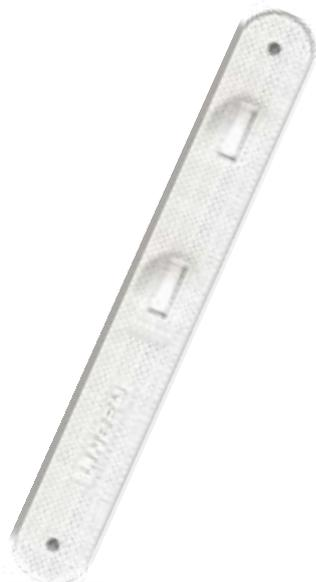
Rilevatore perimetrale UNIVERSALE da esterno in tripla tecnologia: due infrarossi ed una microonda a 24 GHz, copertura a tenda con larghezza 5 m (se installato a 4 m di altezza), per protezioni di porte e finestre. È posizionabile tra finestra e tapparella o persiana, oppure in esterno con l'ausilio del supporto art. 1894SBP (opzionale).
