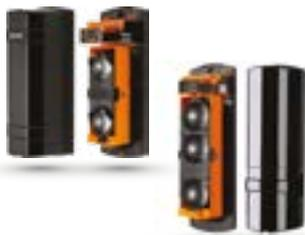
Barriera infrarossi a lunga portata adatta per la protezione di interni ed esterni ed utilizzabile sia per la protezione di uffici che di strutture private. È caratterizzata da contenitore in policarbonato, uscita NA/NC, grado di protezione IP65 è funzionante anche in presenza di cattive condizioni atmosferiche. Montaggio su muro o su palo (Ø 38 – 50 mm). **Numero di fasci: 2.** Distanza di rilevamento: 100 m (esterno); 300 m (interno).
