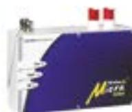
RIVELATORE AD ASPIRAZIONE CON CAMPIONAMENTO LASER MICRA 100 - Range di funzionamento da alta a bassa sensibilità (0,003÷25% obs/m). Due (2) ingressi per tubazione 3/4". Lunghezza massima totale delle tubazioni 100 m (2x50 m). 1 zona di campionamento. Completo di staffa per fissaggio a muro. IP50. Richiede alimentazione esterna 24 Vcc.
