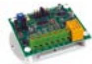
Scheda combinata contaimpulsi per rilevatore di movimento a fune per tapparelle e per sensori inerziali. La selezione di utilizzo, contatto a fune o inerziale, avviene tramite ponticelli, così come la selezione del numero degli impulsi. Non è possibile collegare sulla stessa scheda contatti per tapparelle e contatti inerziali. È fornita di pratico supporto in plastica per il fissaggio.
