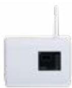
**INTERFACCIA CONVENZIONALE WIRELESS** - Interfaccia convenzionale via radio compatibile con centrali convenzionali di qualsiasi marca. Gestisce fino a 31 dispositivi via radio (26 dispositivi e 5 ripetitori). Frequenza di trasmissione 868-870 MHz 14 dBm su 10 canali. Supporta alimentazione esterna. Certificato EN 54-18 e EN 54-25.
