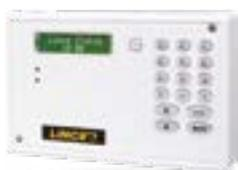
**Combinatore telefonico operante su linea PSTN,** completo di tastiera alfanumerica per la programmazione e display LCD 16 x 2. Due canali di allarme, possibilità di commutare a distanza 2 utenze tramite DTMF; 2 ingressi per la verifica dello stato del carico. Gestione di 8 utenti. Registrazione diretta e riascolto dei messaggi vocali. Batteria ricaricabile inclusa. Dimensioni: 167 x 107 x 33 mm.
