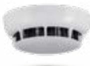
**RIVELATORE DI CALORE NO BASE** - Rivelatore di calore convenzionale che utilizza due NTC per la misurazione precisa dell'ambiente per rivelare il fuoco. Il rivelatore è fornito nella modalità A2S e segnalerà un allarme alla soglia fissa di 55 °C.
