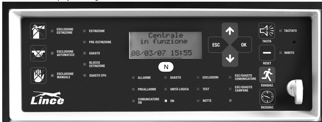
Figura 32 - Segnalazioni di fine riarmo
