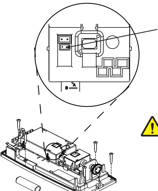
Connettore batteria - Utilizzare il cavo con connettore fornito nella confezione
