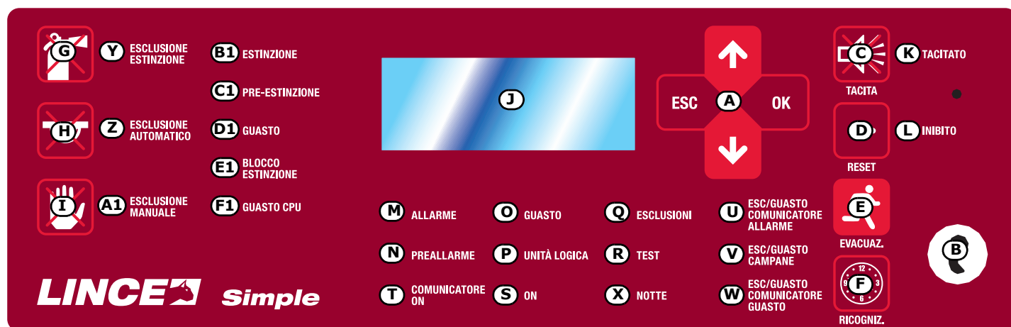
Figura 1 - Pannello frontale della centrale
