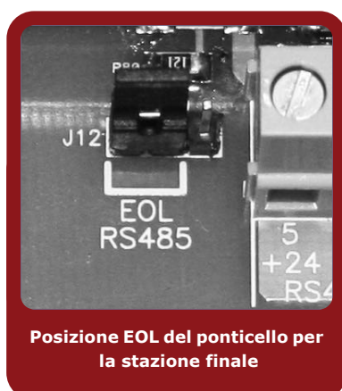
Figura 26 - Scheda EasyLevel - posizione del ponticello
