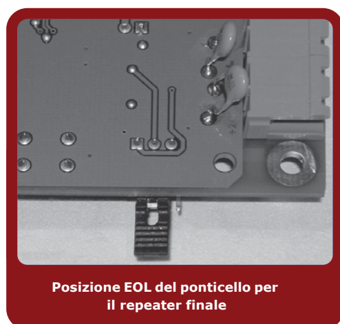
Figura 25 - Scheda EASYPAN/LCD - posizione del ponticello
