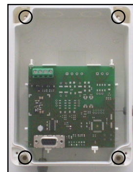
Figura 5 - Fori per le viti di fissaggio a parete
