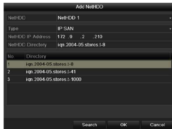
Figura 13-9 Aggiunta di un disco IP SAN
