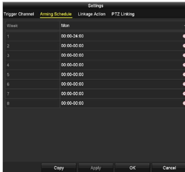
Figura 7-7 Impostazione della programmazione per l'ingresso di allarme
