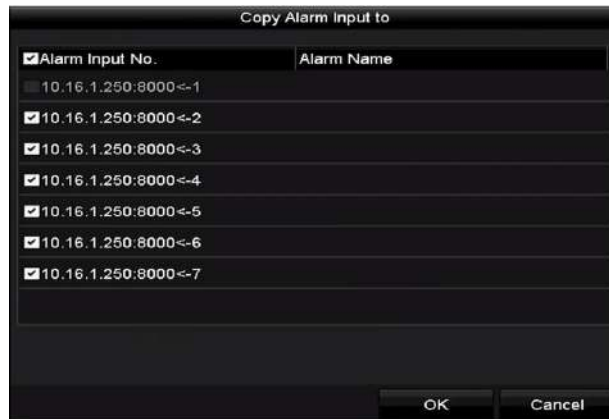
Figura 4-20 Copia dell'ingresso di allarme
